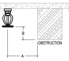
FIGURE 8.10.6.1.2(A) IONING OF SPRINKLERS TO AVOID BSTRUCTION TO DISCHARGE
